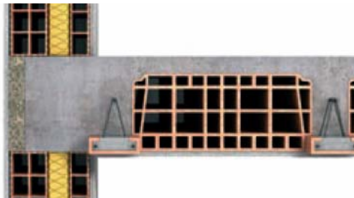
Isolamento nodo soletta – muratura
